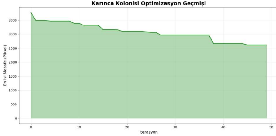
Şekil 9. Karınca koloni algoritması ile elma toplama yörünge mesafe optimizasyonu.
