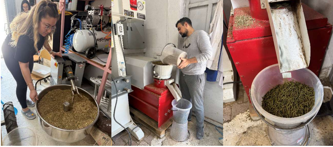
Figure 2 Pelet pres makinesi kullanılarak pelet elde edilmesi
