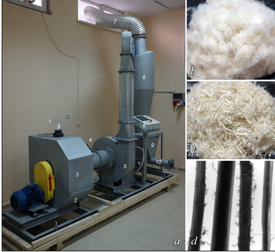
Şekil 3. Tavuk tüyünden lif üretim makinesi ve üretim çıktıları
