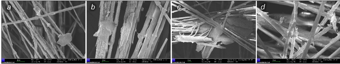
Şekil 12. Islak (a, b) ve kuru serme (c, d) ile üretilmiş numunelerin iç kesit fragmanları
